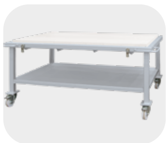
Tafels voor de uitbreiding van het ovensysteem voor modellen GFM; wissel tafelsysteem voor het gebruik van de restwarmte van de oven en ter verkorting van de cyclustijden door een tafelwissel in warme toestand.
