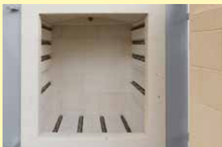
Verwarming aan drie kanten, verwarmingselementen beschermd in groeven
