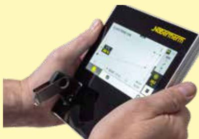
Opnemen van procesgegevens van de aangesloten controller per usb-stick.
