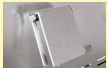
Afsluitbare toevoerluchtopening voor de beluchting, de snellere afkoeling en de observatie van de charge
