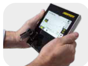
Afneembare controller met touch-bediening
