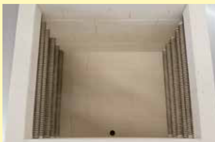
Verwarmingselementen op draagbuizen zorgen voor een vrije warmteafstraling
