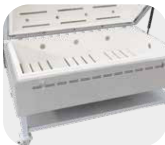
Tafels voor de uitbreiding van het ovensysteem voor modellen GFM; wissel tafelsysteem voor het gebruik van de restwarmte van de oven en ter verkorting van de cyclustijden door een tafelwissel in warme toestand.
