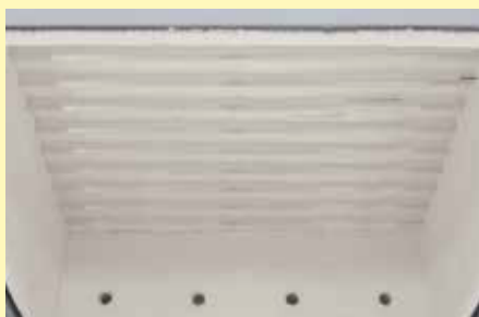
Dicht naast elkaar aangebrachte, in kwartsglasbuizen beschermde verwarmingselementen in de kap
