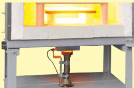
15 kW propaangasbrander gemonteerd onder de oven
